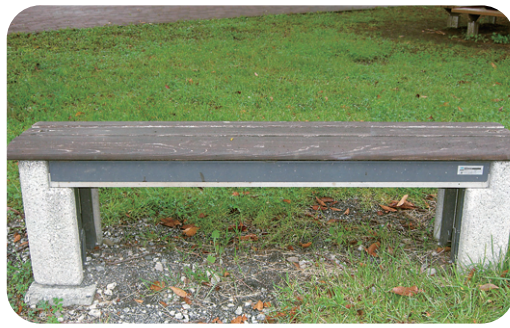
かまどベンチ 普段はベンチですが、災害時には座る部分を外して、「かまど」として炊き出しなどに用いることができます。
