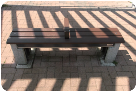
かまどベンチ 普段はベンチですが、災害時には座部分を外して、「かまど」として炊き出しなどに用いることができます。
