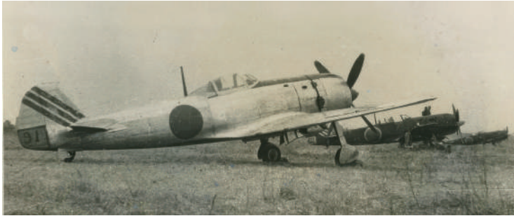
誉（ハ-45）エンジンが搭載 とうさい され、日本の最高傑作機 けっさく と言われた四式戦闘機「疾風」 はやて （日本航空協会提供）
